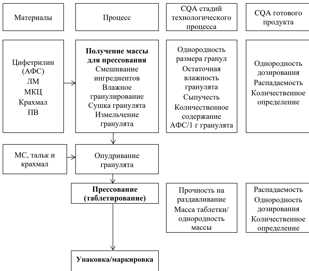
Рисунок 46 – Связь между операциями технологического процесса получения таблеток цифетрилина и критичными показателями качества
