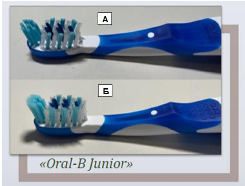
Рисунок 26 – Щетина зубной щетки «Oral-B Junior» для детей от 6 до 12 лет: А - до применения; Б - после использования в течение трех месяцев
