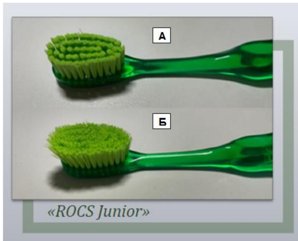
Рисунок 27 – Щетина зубной щетки «ROCS Junior» для детей от 6 до 12 лет: А - до применения; Б - после использования в течение трех месяцев
