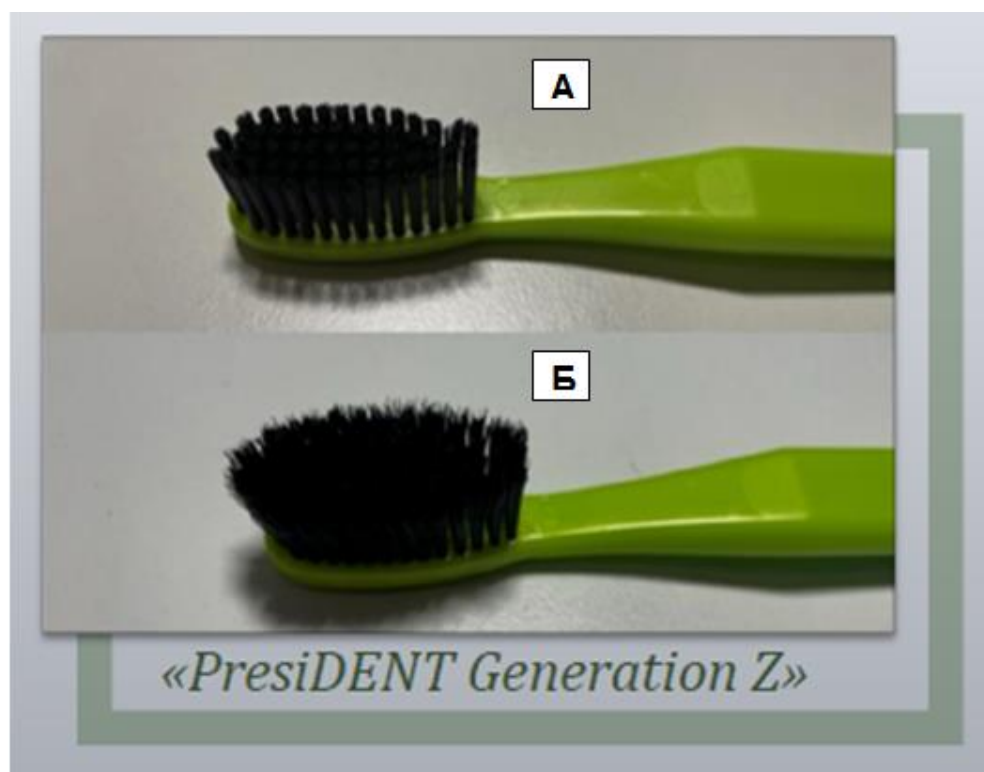
Рисунок 29 – Щетина щетки «PresiDENT Generation Z» мягкая для детей от 12 лет: А - до применения; Б - после использования в течение трех месяцев
