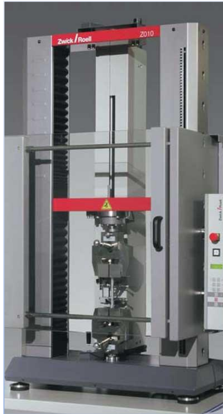
Рисунок 2 – Аппарат для определения жесткости щетины «Zwick/Roell Z010» («Zwick GmbH&Co.KG», Германия)
