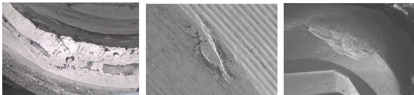
Рисунок 4 – Примеры деформации и дефектов платформы удаленных имплантатов (электронная микроскопия x до 2000 раз)
