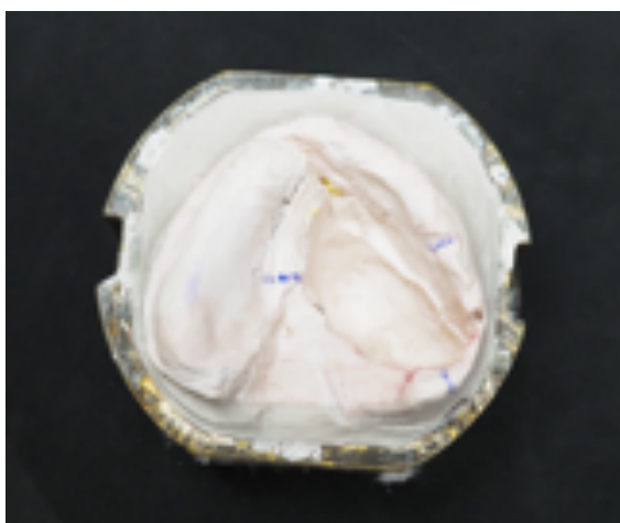
Рисунок 30 — Гипсовая форма после выварки воска, нанесены три ориентирные линии для восковой пиллюли.
