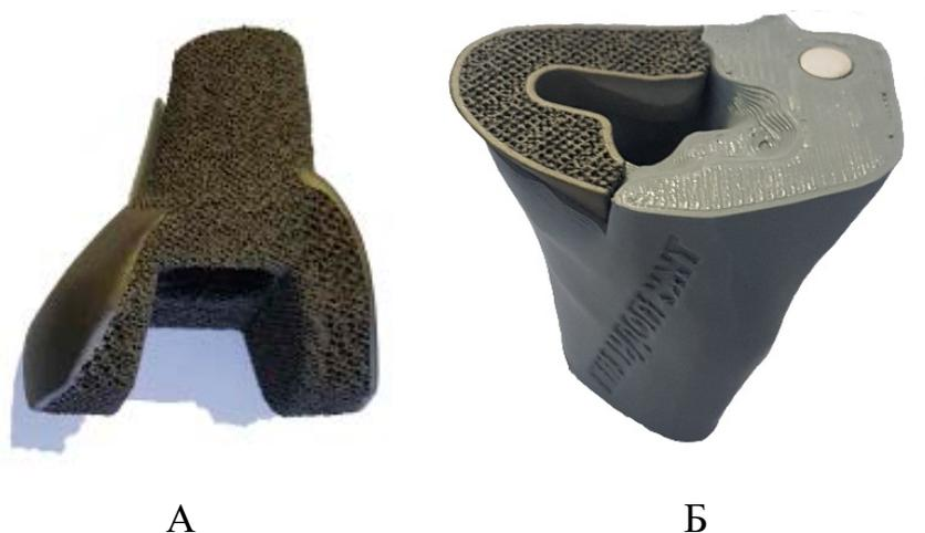
Рисунок 4.40 – Готовые изделия: А – титановый компонент для замещения проксимального отдела бедренной кости; Б – индивидуальный титановый аугмент для замещения дефекта большеберцовой кости
