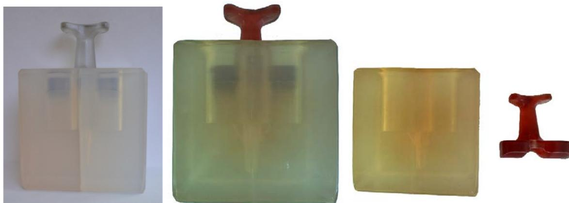
Рисунок 5.4 – Силиконовые формы с поршнем для формирования большеберцового компонента спейсера
