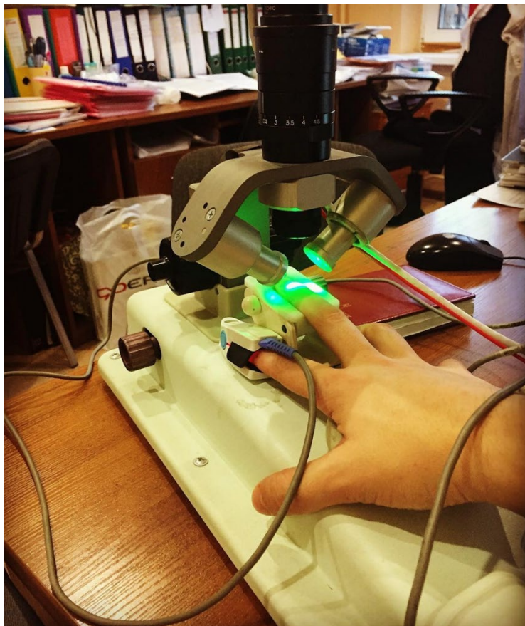
Рисунок 2.4 – Внешний вид капилляроскопа «Капилляроскан-1»
