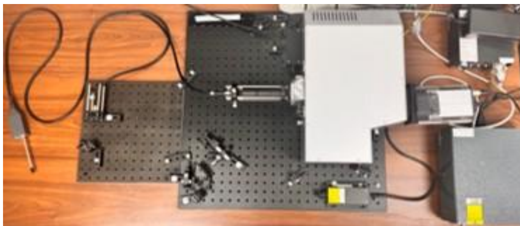
Рисунок 2.7 – Общий вид установки для Рамановской спектроскопии
