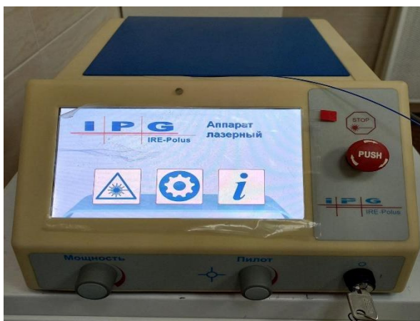
Рисунок 14 – Скальпель лазерный ЛСП-«ИРЭ-полюс» с длиной волны 1,94 мкм
