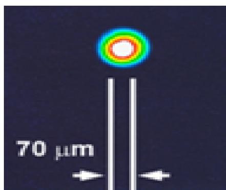
Рисунок 12 – Срез лазерного луча TFL на месте коннектора хирургического волокна
