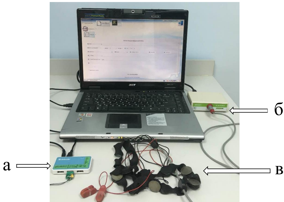
Рисунок 5 – Аппаратно-диагностический комплекс ТЭТОС: а – блок регистрации и обработки информации, б – блок формирования электроимпульсных сигналов, в – головной шлем с электродами
