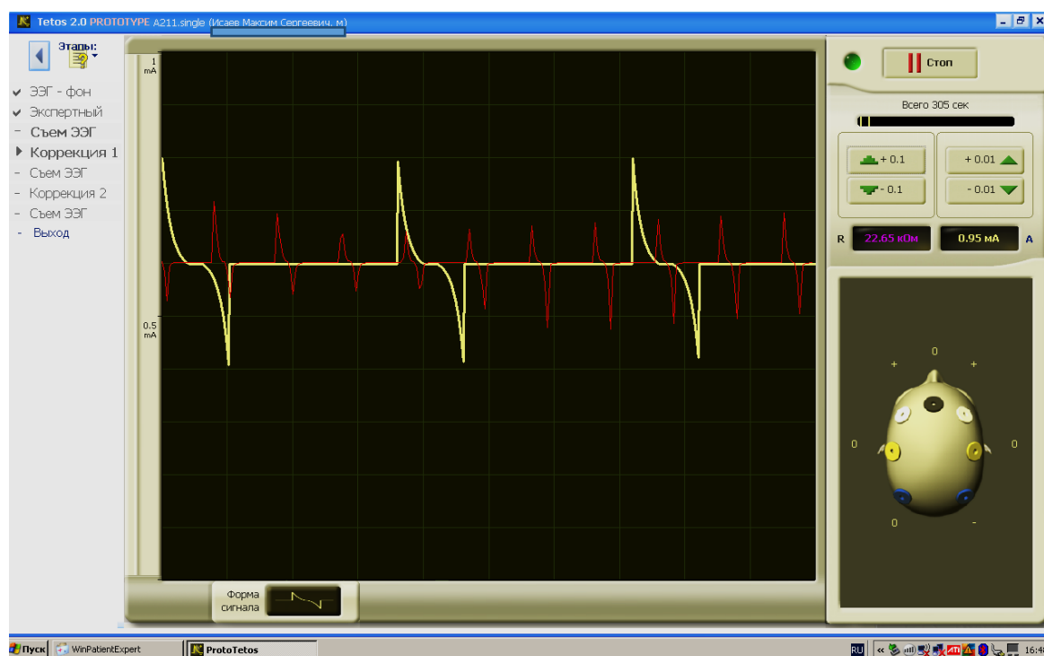
Рисунок 11 – Вид биполярно-экспоненциального импульса в работе на ТЭТОС
