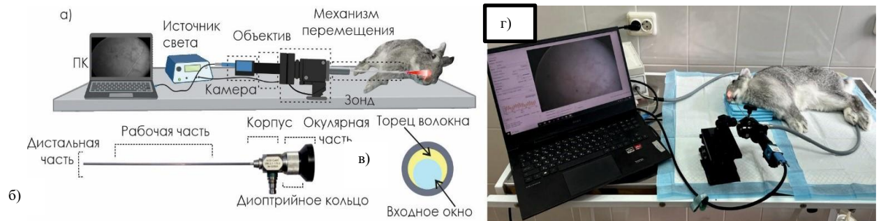
Рисунок 5 – Схематическое изображение процедуры фотоплетизмографии: а) – общая схема экспериментальной установки, б) – общая схема устройства зонда, в) – схематическое изображение дистальной части зонда, г) этап проведения эксперимента
