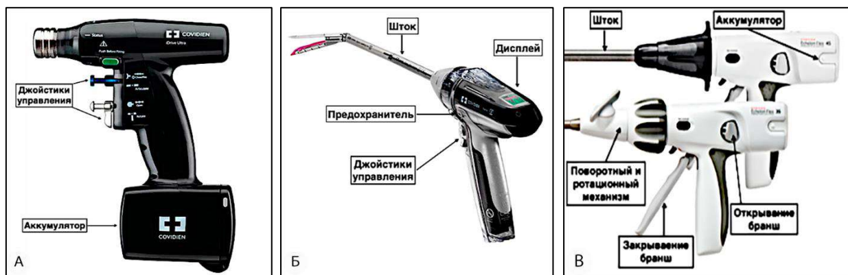
Рисунок А.13 – Электрические линейные степлеры. А. Первое поколение iDrive™ (фото с сайта www.art-eco.pro [454]); Б. Второе поколение Signia™ Stapling System (фото с сайта www.medtronic.com [447]); В. Сосудистый линейный степлер ECHELON FLEX PVS с технологией DST™ (Ethicon, США, фото с сайта www.medichome.ru [452])
