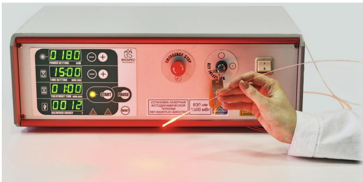
Рисунок 2.28 – Диодный лазер ЛФТ-01-БИОСПЕК с длиной волны 665 \pm 3 нм
