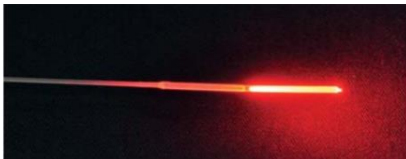
Рисунок 2.29 – Оптический диффузор с цилиндрическим облучателем на дистальном конце
