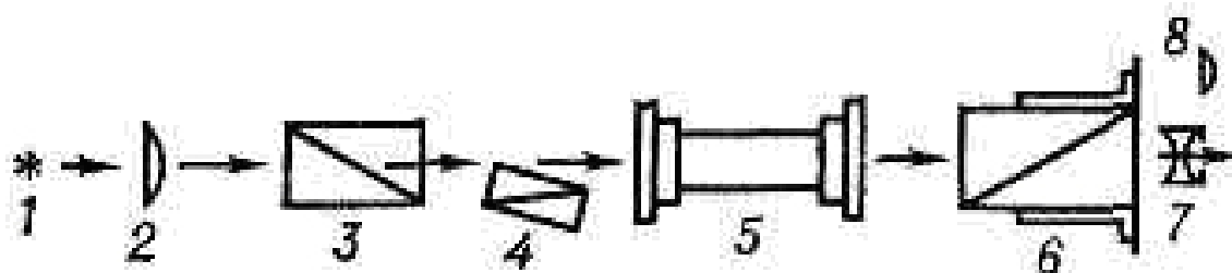
Рис. 1. Принципиальная схема полутеневого поляриметра: 1 — источник света; 2 — конденсор; 3, 4 — полутеневая призма; 5 — трубка с исследуемым оптически активным веществом; 6 — анализатор с отсчётным устройством; 7 — зрительная труба; 8 — окуляр отсчётного устройства.
