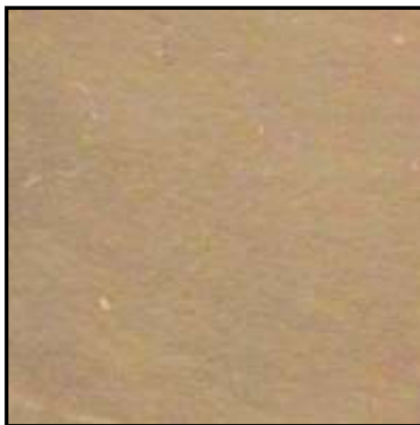
Рисунок 2.2 – Внешний вид мембраны PLA, полученной методом электроспиннинга
