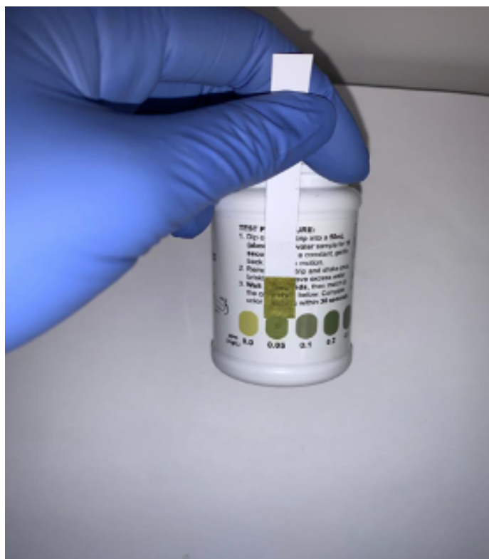
Рисунок 7 – Сравнение изменения цвета индикаторной тест-полоски со шкалой концентрации озона в воде
