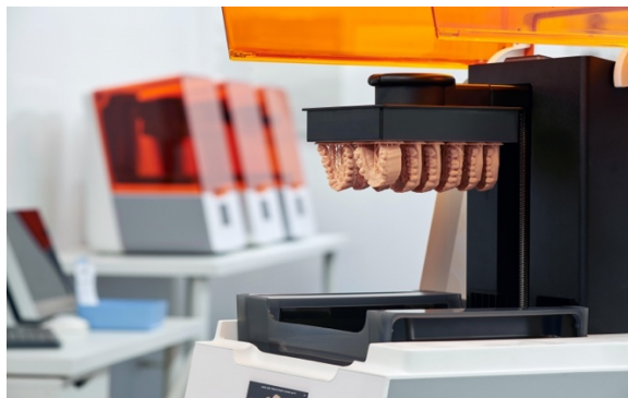
Рисунок 23 - Лабораторный этап изготовления элайнеров: планирование перемещения зубов в программе, выгрузка stl моделей зубов в 3д принтер, печать моделей
