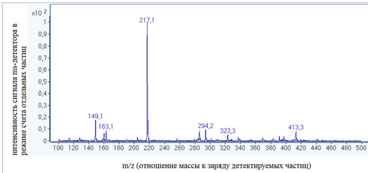
Рисунок 22 – Спектр дочерних ионов. Определение m/z иона-продукта (217,1) летрозола
