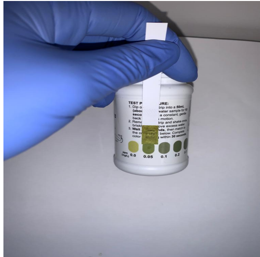
Рисунок 5 – Сравнение изменения цвета индикаторной тест-полоски со шкалой концентрации озона в воде
