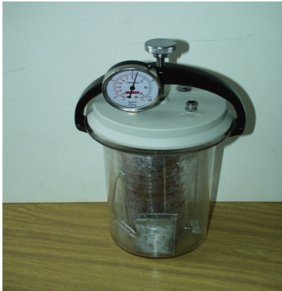
Рисунок 6 – Культивирование анаэробной микробной флоры в условиях анаэробноза (анаэростат фирмы «Himedia Labs»)
