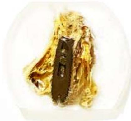
Рисунок 3 – Распил образца, залитого в пластмассу, через ось имплантата
