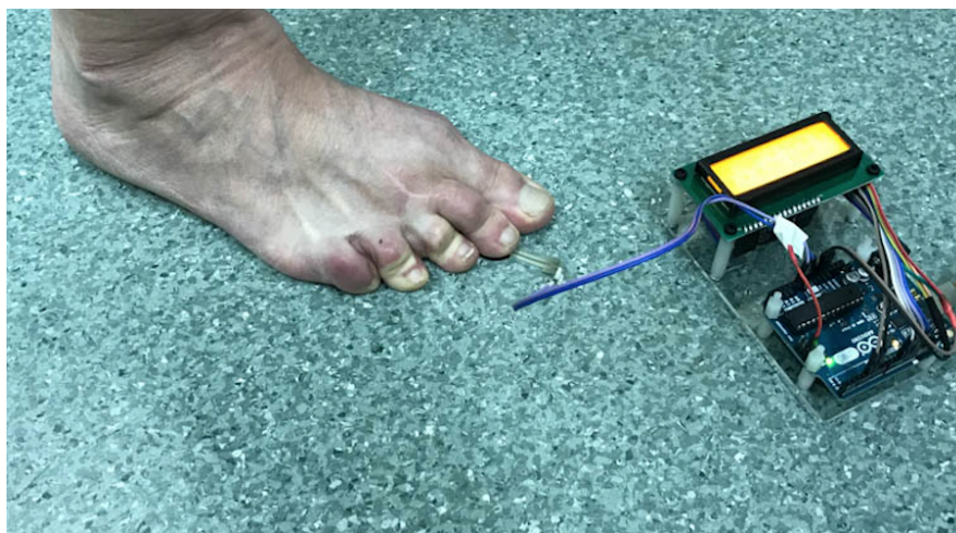
Рисунок 11. Применение датчика локальной подобарометрии в оценки давления под головкой плюсневой кости.
