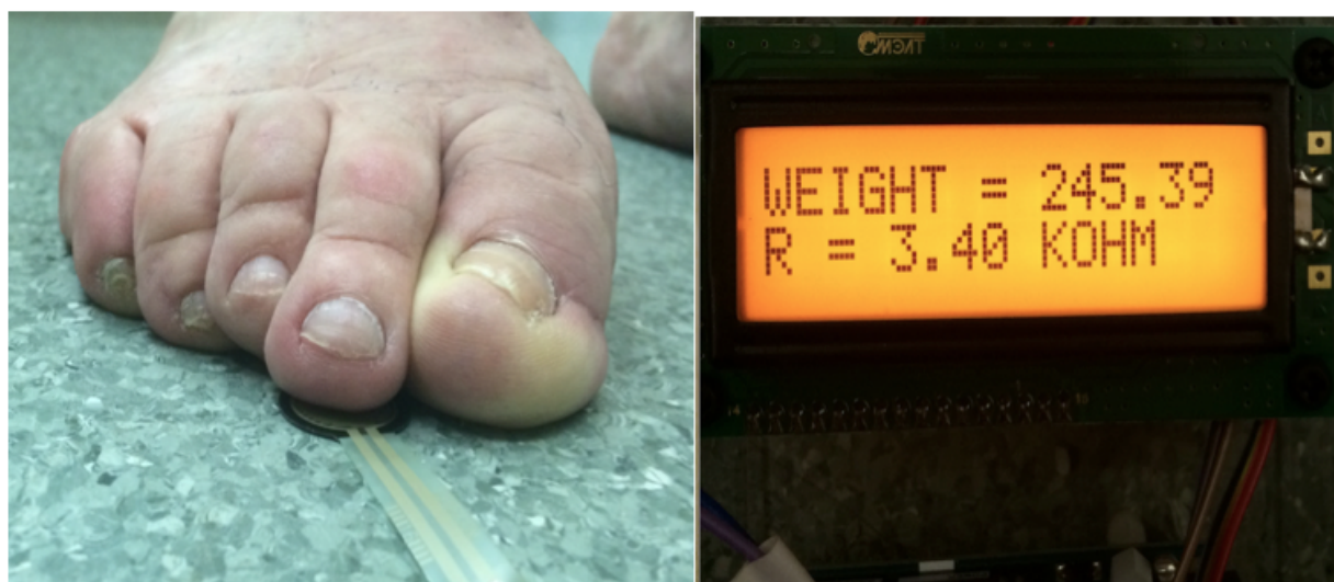
Рисунок 12. Применение датчика локальной подобарометрии в оценки давления под дистальной фалангой пальца.
