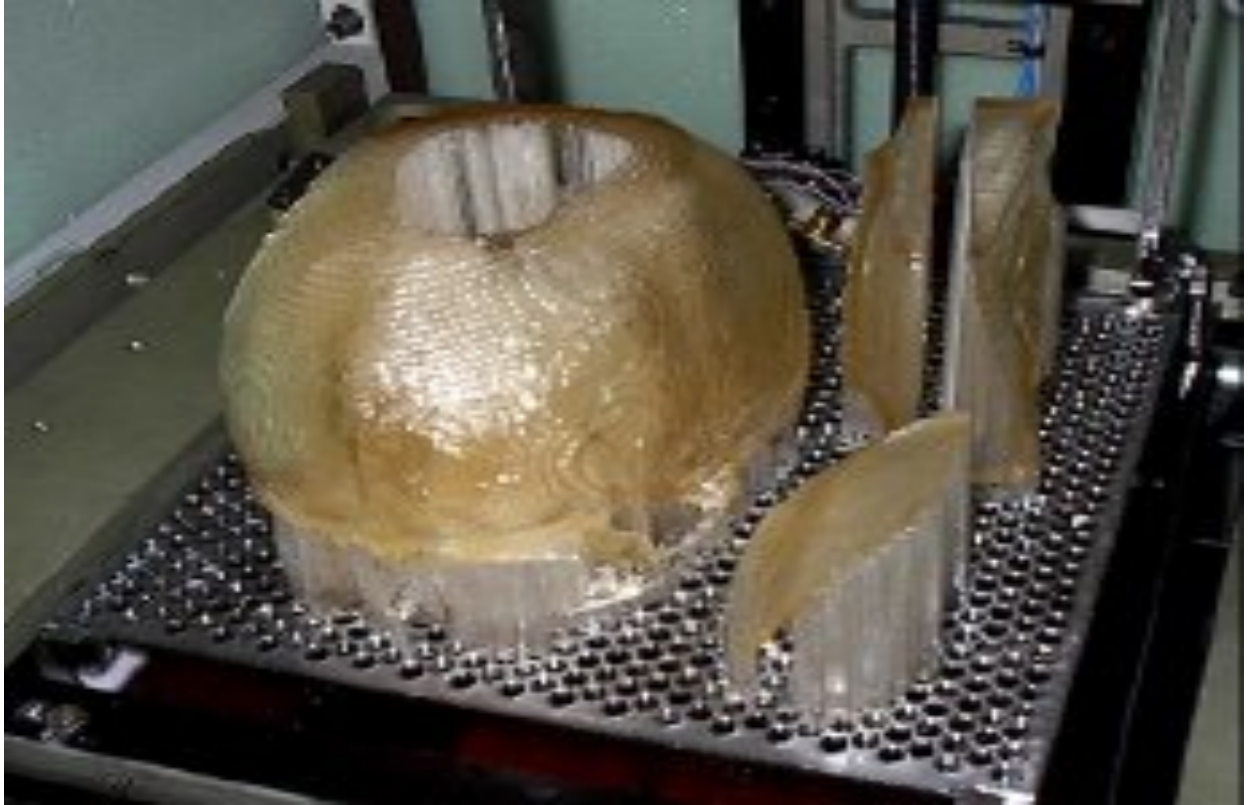
Рисунок 12. Процесс изготовления стереолитографической модели, закрепленной на платформе стереолитографа при помощи опорных элементов.
