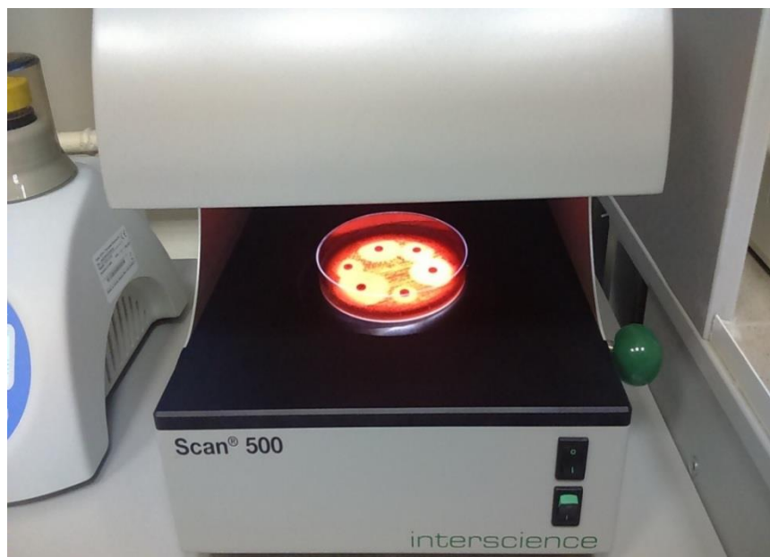
Рисунок 2.4 – Учёт результатов количественного посева на аппарате «Scan 500» (Interscience, Франция)
