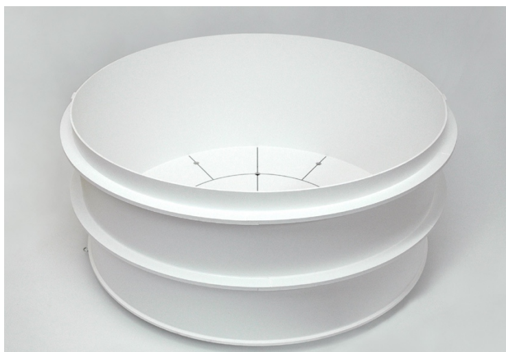
Рисунок 5 – Установка «открытое поле» ООО НПК «Открытая наука», использованная в эксперименте для изучения поведения животных
