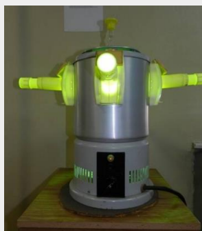
Облучатель ультрафиолетовый ОУФ для групповых облучений (УГН-1)
