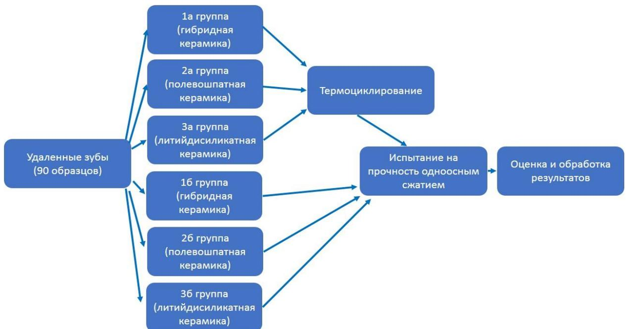
Рисунок 1 – Схема лабораторного исследования
