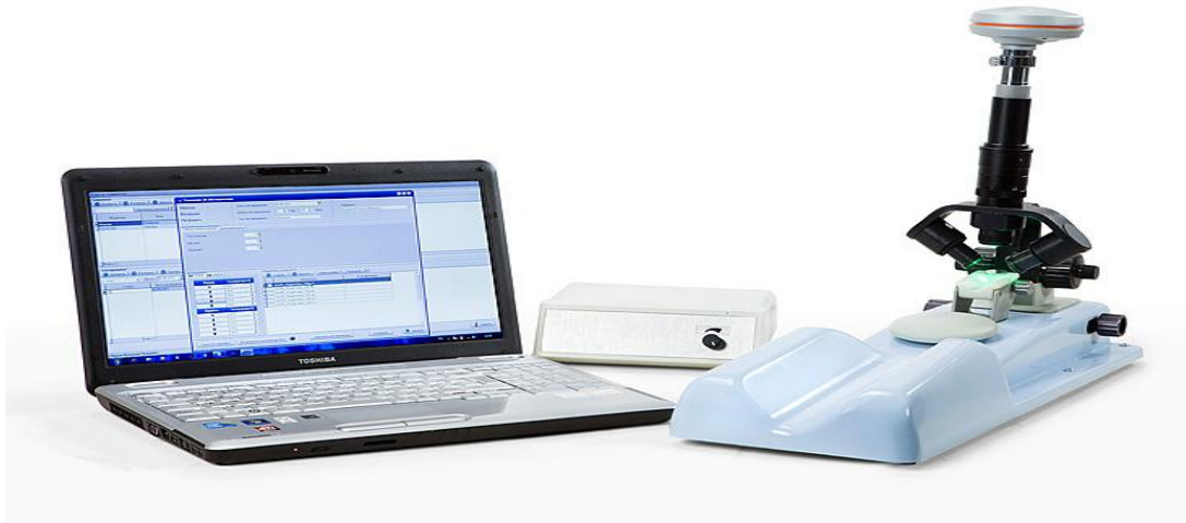
Рисунок 2.8 — Внешний вид капилляроскопа «Капилляроскан-1»
