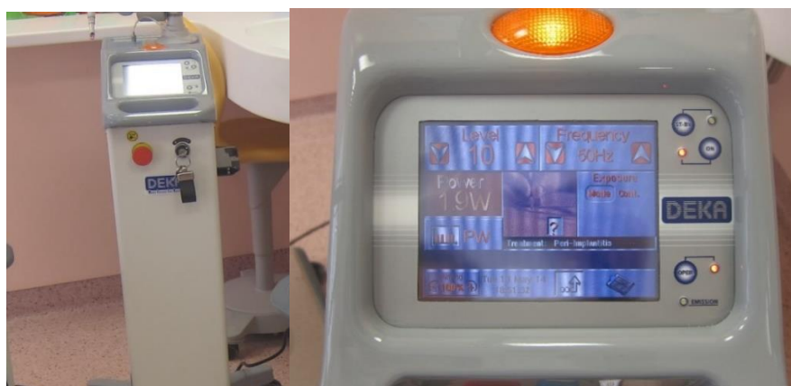
Рисунок 47 – Углекислотный лазер SMART US-20D DEKA (Италия), длина волны 10600 нм
