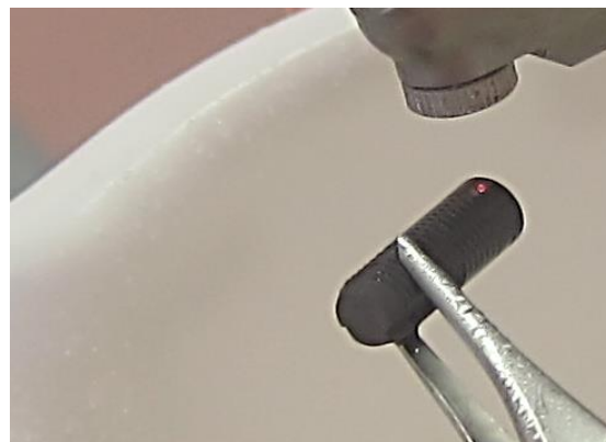
Рисунок 8 – Воздействие на поверхность дентального имплантата «Dentium» излучением CO 2 лазера «Smart US20D» мощностью 1,0 Вт
