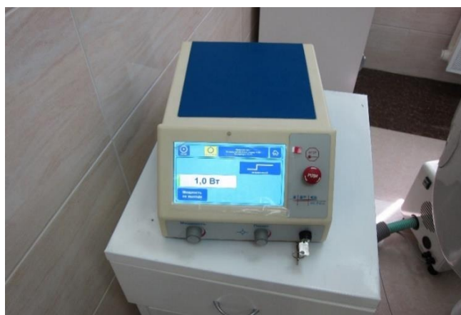
Рисунок 48 – Лазер «ИРЭ-Полус 0,97 мкм/10Вт» (Россия) с длиной волны 970 нм
