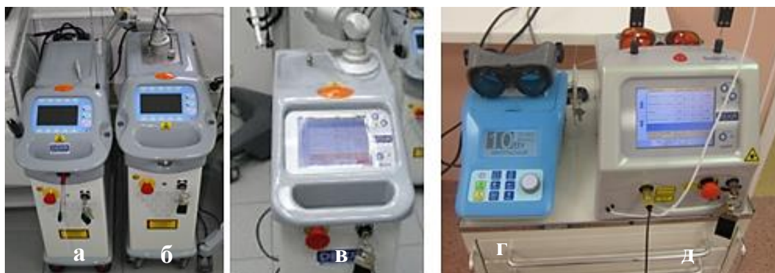
Рисунок 5 – Лазерные системы: Nd:YAG «Smarti A10» DEKA (а), Er:YAG «Smart 2940D plus» DEKA (б), CO 2 «Smart US20D» DEKA (в), ЛСП «ИРЭ-Полус» (Россия) (г), KTP-Nd:YAG «Smart Lite» DEKA (д)
