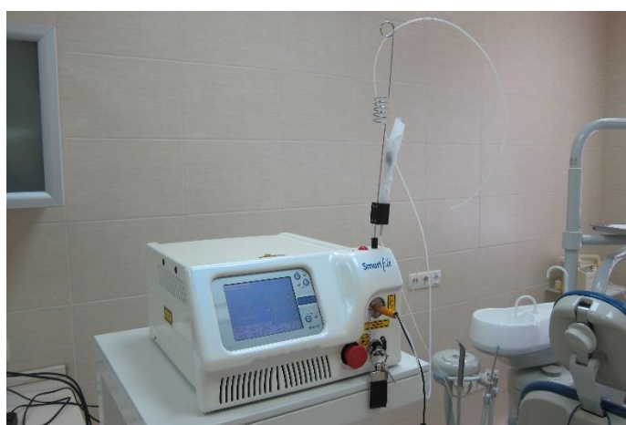
Рисунок 42 – Неодимовый лазер «SMARTFILE» DEKA (Италия) с длиной волны 1064 нм
