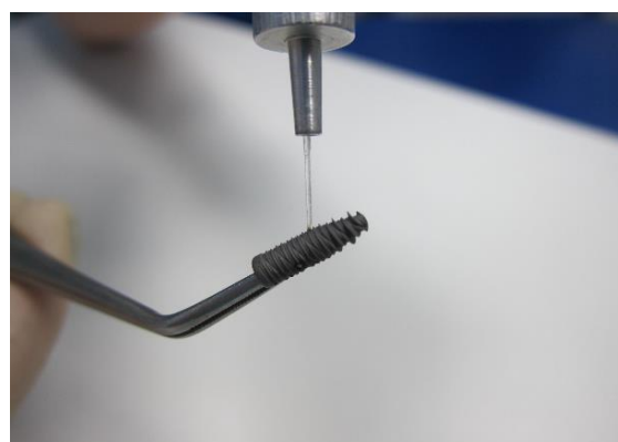
Рисунок 10 – Воздействие на поверхность имплантата «OsseoSpeed, Astra Tech» излучением лазера ЛСП «ИРЭ-Полюс» мощностью 1,0Вт
