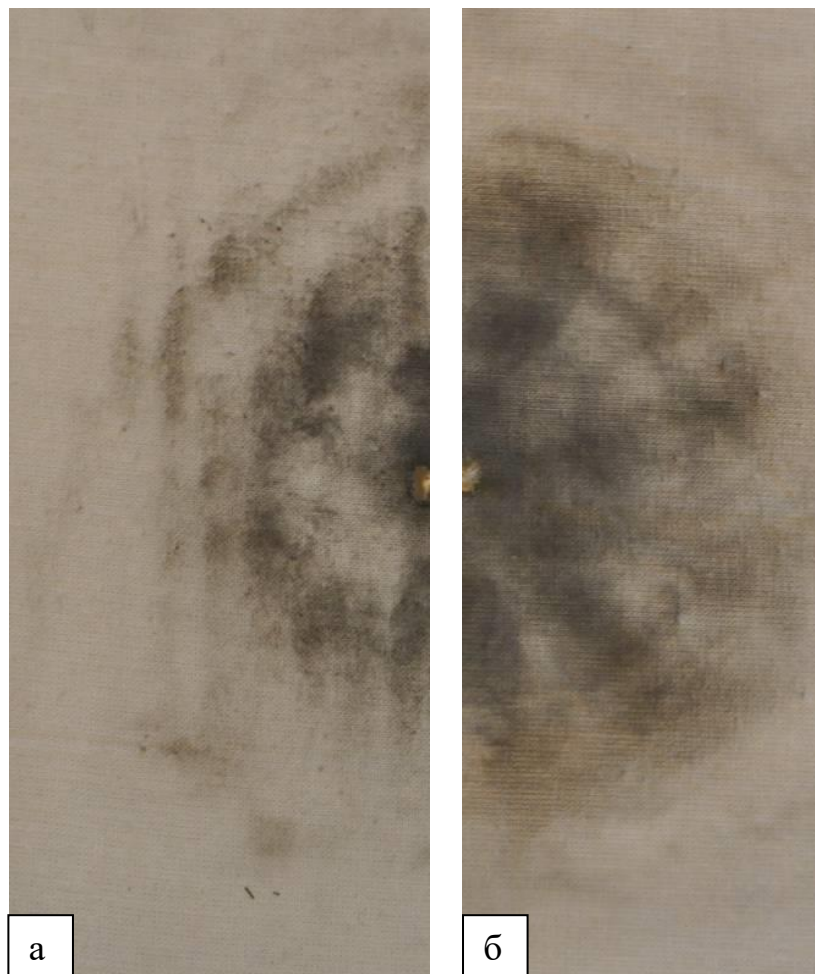
Рисунок 35 – Термическое действие пламени выстрела на мишень с расстояния выстрела 5 см: а) - мокрая мишень, б) - сухая мишень
