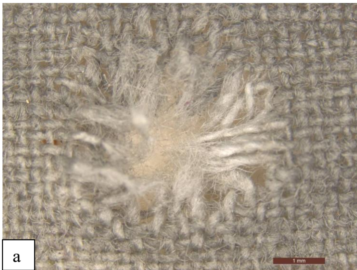
Рисунок 27 – Повреждение сухой бязевой мишени, причиненное выстрелом из пистолета Glock 17 с расстояния 5 см: морфология повреждения (а), общий вид (б)
