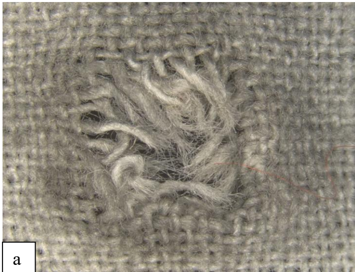
Рисунок 22 – Повреждение мокрой бязевой мишени, причиненное выстрелом из пистолета Glock 17 с расстояния 10 см: морфология повреждения (а), общий вид (б)
