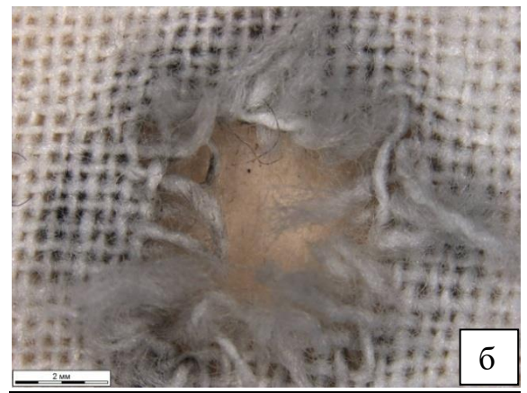
Рисунок 29 – Повреждение сухой бязевой мишени, причиненное выстрелом из пистолета Glock 17 с расстояния 40 см: лицевая сторона мишени (а), изнаночная сторона мишени (б)
