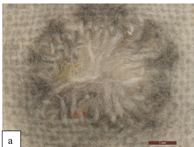
Рисунок 6 – Повреждение мокрой бязевой мишени, причиненное выстрелом из пистолета Ярыгина с расстояния 20 см: морфология повреждения (а), общий вид (б)
