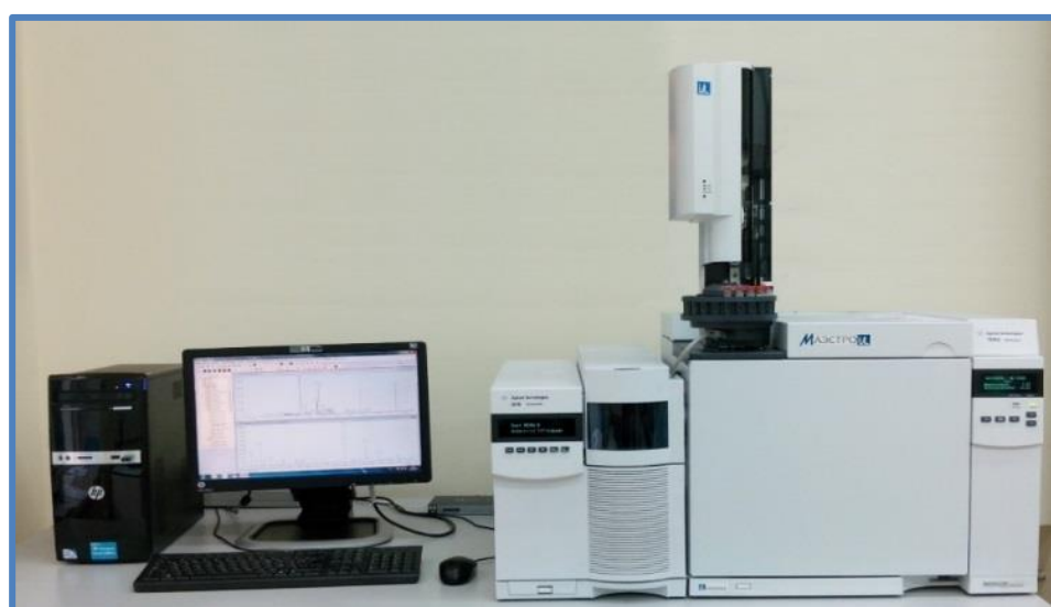
Рисунок 6 – Микробиологический анализатор «МАЭСТРО»
