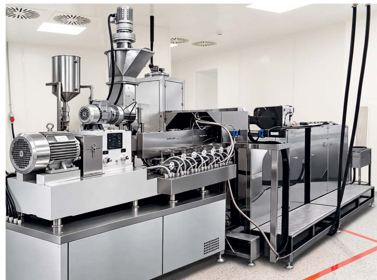
Технологическая линия для производства полволоконных мембран медицинского назначения из расплавов полимеров
