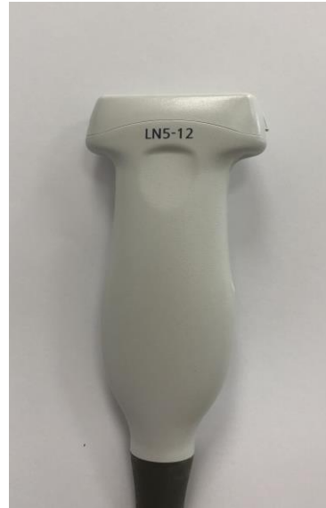
Рисунок 2 - Высокочастотный линейный датчик LN5-12
