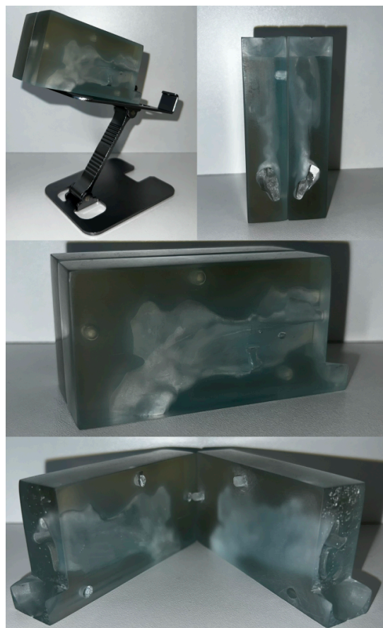
Рисунок 2.2 – Внешний вид сборной модели носовой полости, сконструированной для исследования
