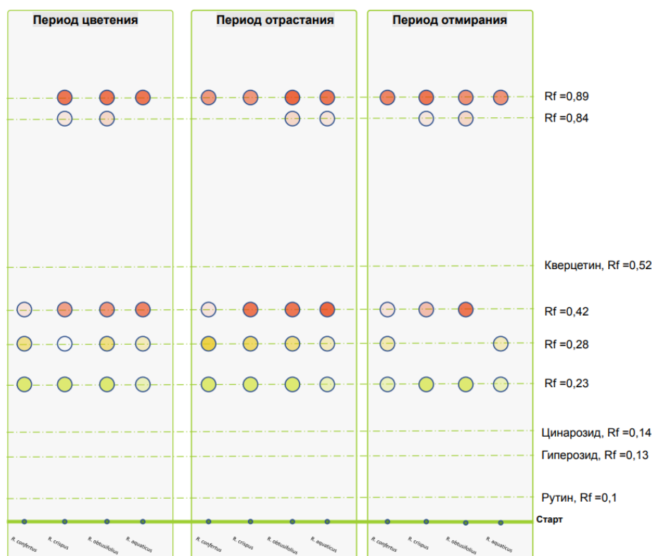
Рисунок 47 – Хроматограммы спирто-водных извлечений, полученные по методике ТСХ анализа «ФЛТ»
