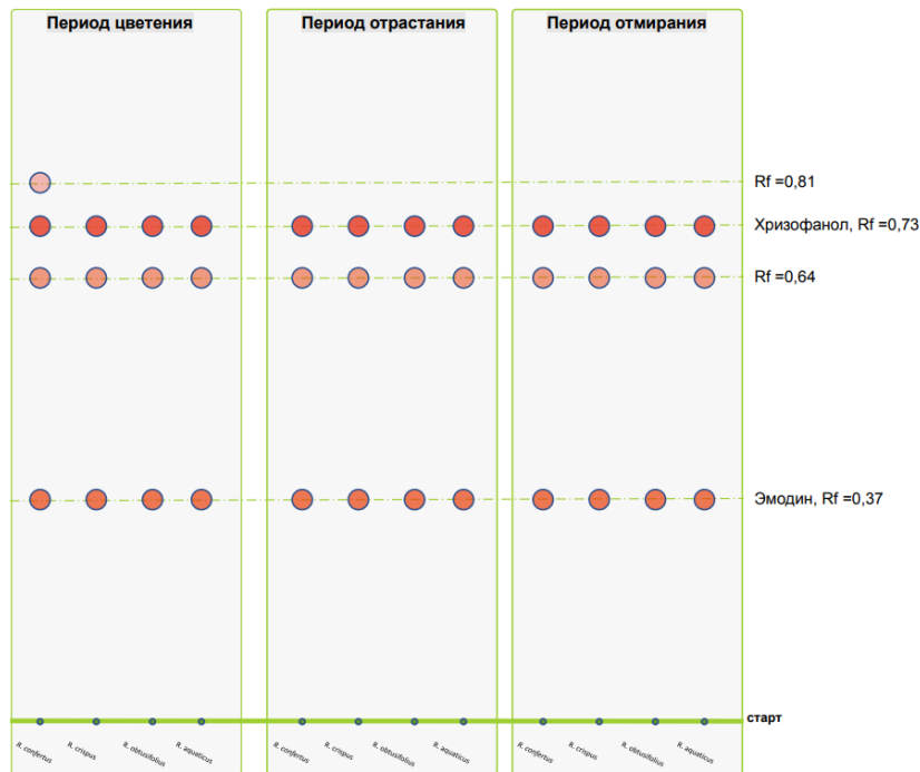
Рисунок 39 – Хроматограммы спирто-водных извлечений, полученные по методике ТСХ анализа «АПТ»
