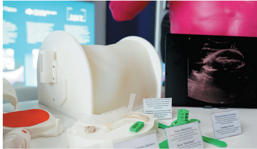
Все элементы тренажера созданы путем 3D-моделирования из уникальных тканезквивалентных материалов
