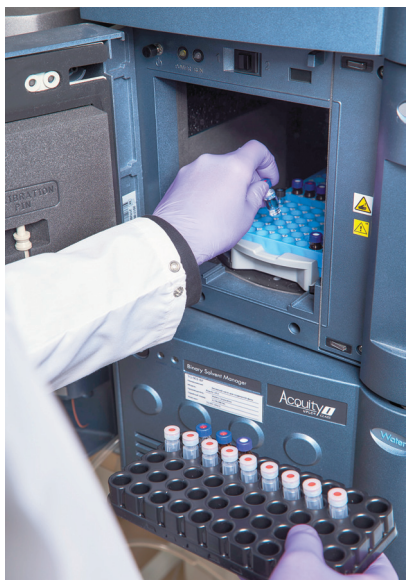
Момент загрузки подготовленных индивидуальных образцов в автосамплер системы ВЭЖХ-МС/МС
