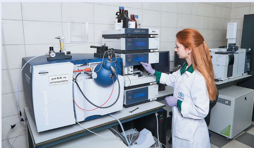
Настройка системы высокоэффективной жидкостной хроматографии перед запуском анализа метаболома
