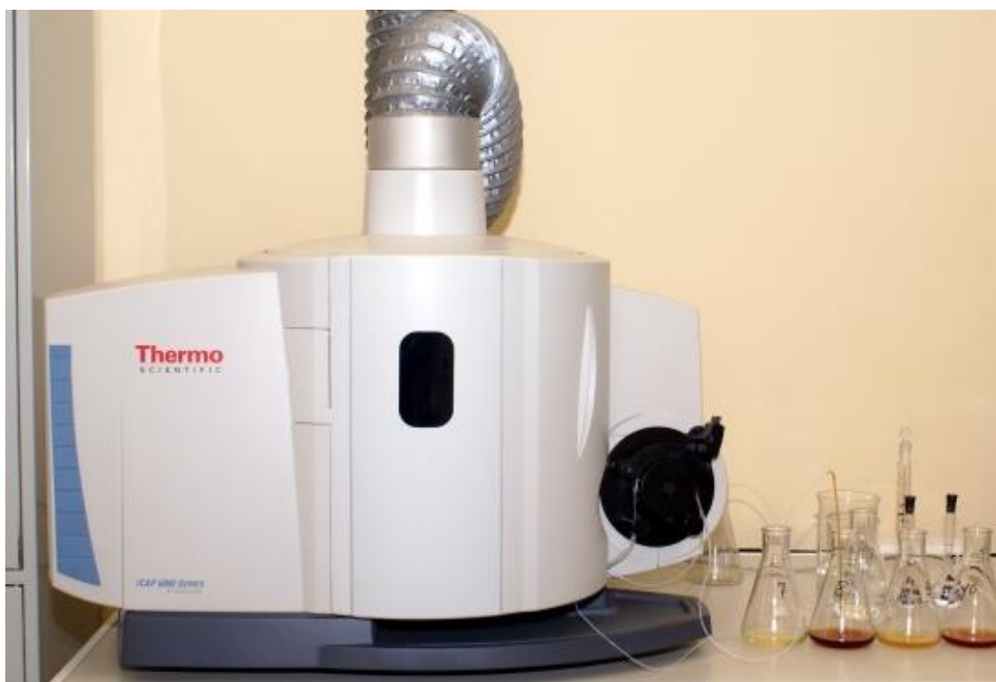
Рисунок 8 – Масс-спектрометр iCAP 6300 Radial View («Thermo Fisher Scientific Inc.», США)
