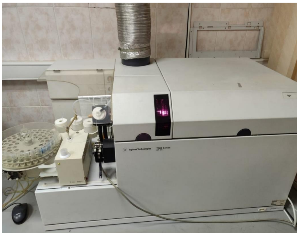
Рисунок 7 – Масс-спектрометр ICP-MS 7500 Series («Agilent Technologies Inc.», США)
