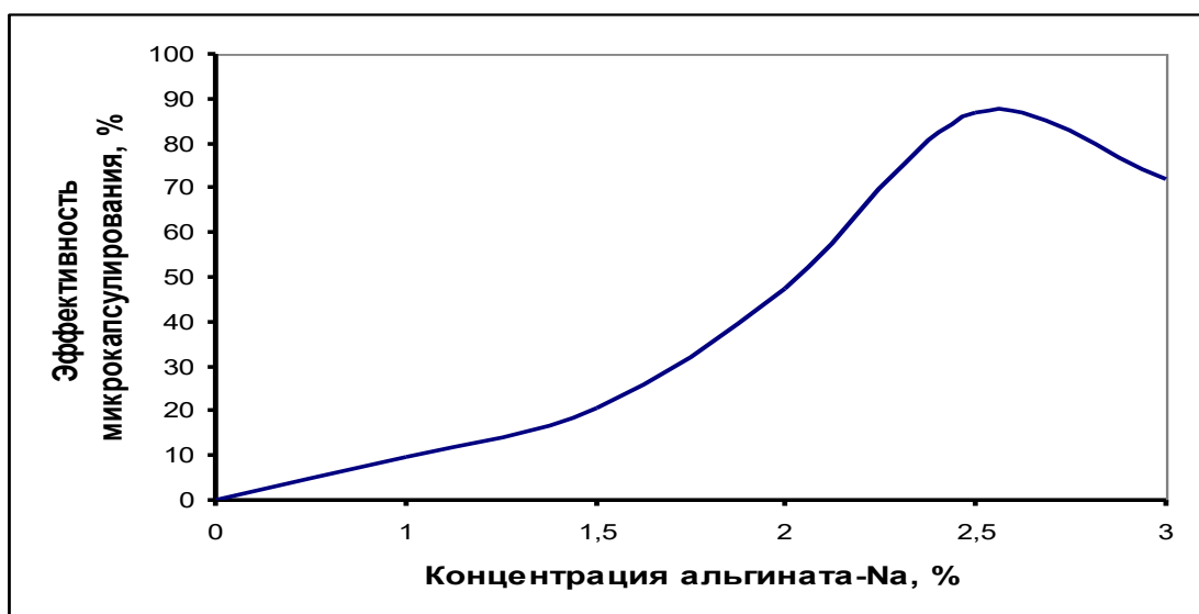
Рисунок 37 – Зависимость эффективности микрокапсулирования от концентрации раствора АН
