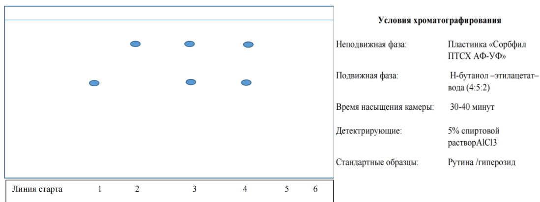
Рисунок 16 - Схема хроматограммы определения флавоноидов: 1 СО рутин, R_f = 0,34 , 2 СО гиперозида, R_f = 0,6 , 3–4 спиртовое извлечение, 5–6 водное извлечение
