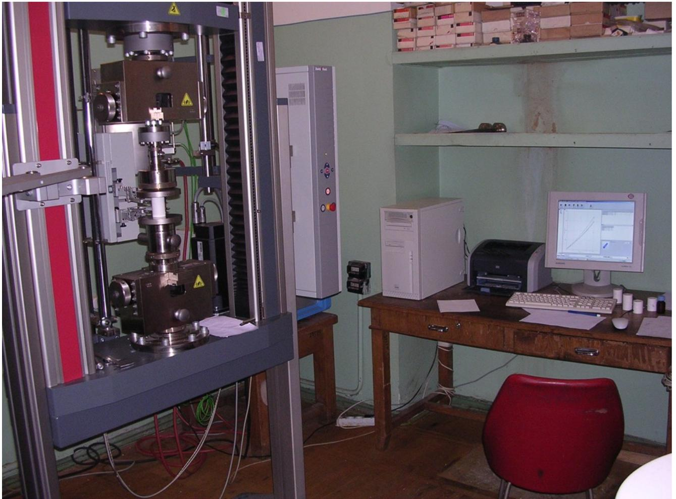
Рисунок 4 – Испытательная машина ZWICK Z100 (общий вид)
