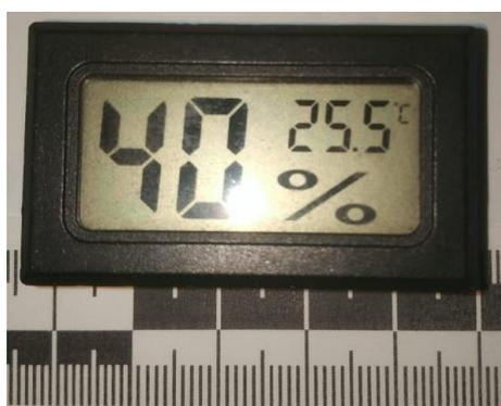
Рисунок 2.2 – Цифровой термометр с гигрометром YS-02
