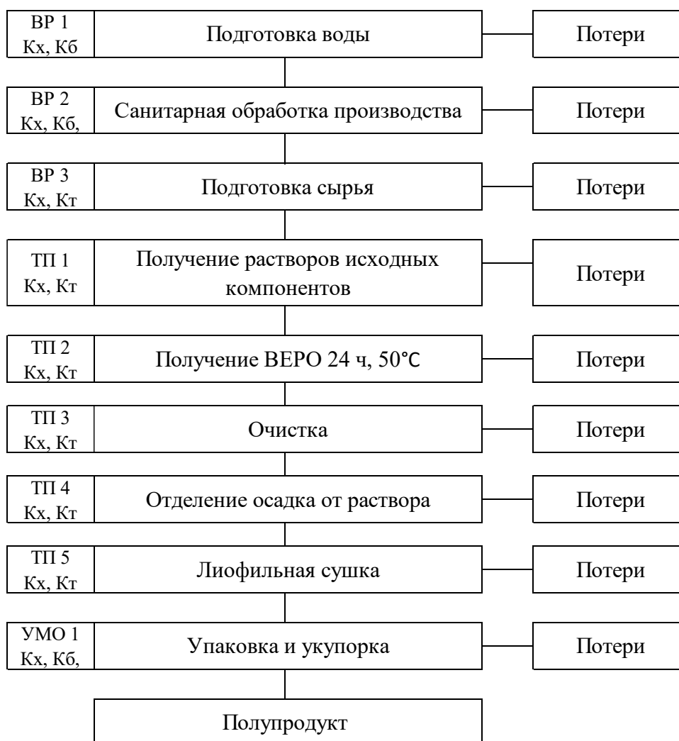
Рисунок 5 – Технологическая схема получения модифицированной формы ЕРО с применением 4БФБК с указанием основных стадий технологического процесса (где ВР – вспомогательные работы, ТП – технологический процесс, УМО – упаковка, маркировка, отгрузка, Кх, Кт, Кб – контроль химический, технологический, биологический)
