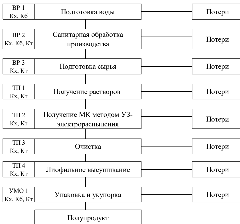
Рисунок 7 – Технологическая схема получения микрокапсул, покрытых ВЕРО, с указанием основных стадий технологического процесса
