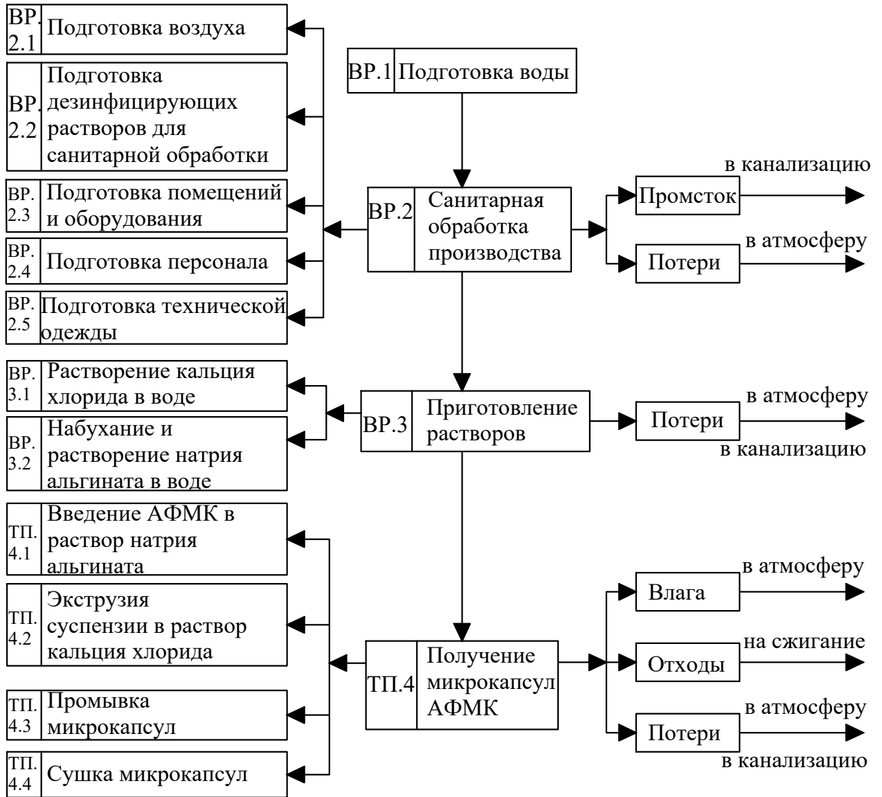
Рисунок 6 – Технологическая схема производства микрокапсул АФМК
