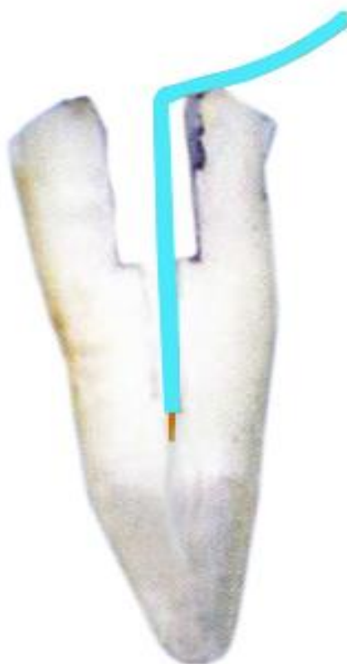
Рисунок 16 – Размещения медных и серебряно-медных электродов для анодного растворения внутри канала
