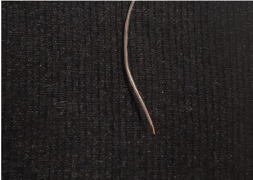
Рисунок 14 – Одножильный медный электрод, используемый для внутриканального анодного растворения
