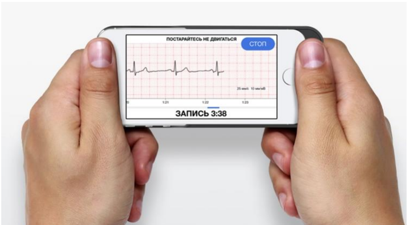
Рисунок 3 – А. Одноканальный портативный электрокардиограф «CardioQVARK» с датчиками для регистрации фотоплетизмографии и электрокардиограммы; Б. Процесс записи одноканальной электрокардиограммы
