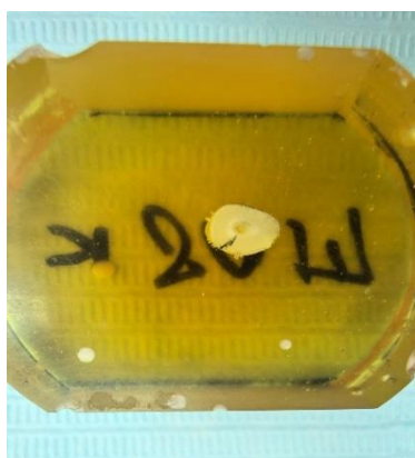
Рисунок 13 – Образцы из группы 1 «Без активации» (А) и из группы 2 «Звуковая активация» (Б) в блоках эпоксидного клея со следами от замера
