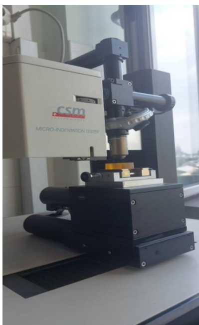
Рисунок 12 – Твердомер для измерения микротвердости с установленным образцом (А); этап калибровки алмазного индентора (Б)
