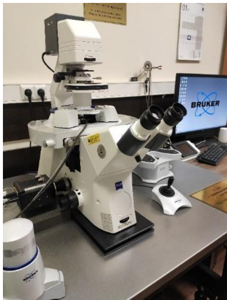
Рисунок – 16. Атомно-силовой микроскоп, использованный в исследовании
