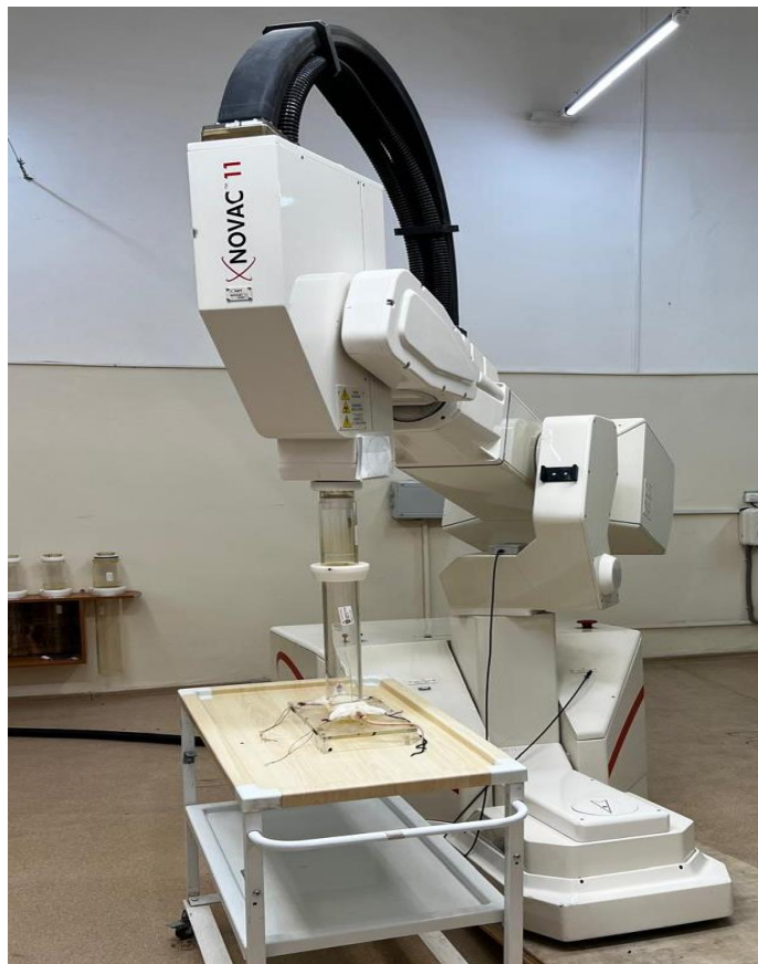
Рисунок 2.2 – Импульсный ускоритель электронов «NOVAC-11» (S.I.T. Sordina IORT Technologies S.P.A., Италия) и размещение животных на предметном столе в распорках на «салазках»
