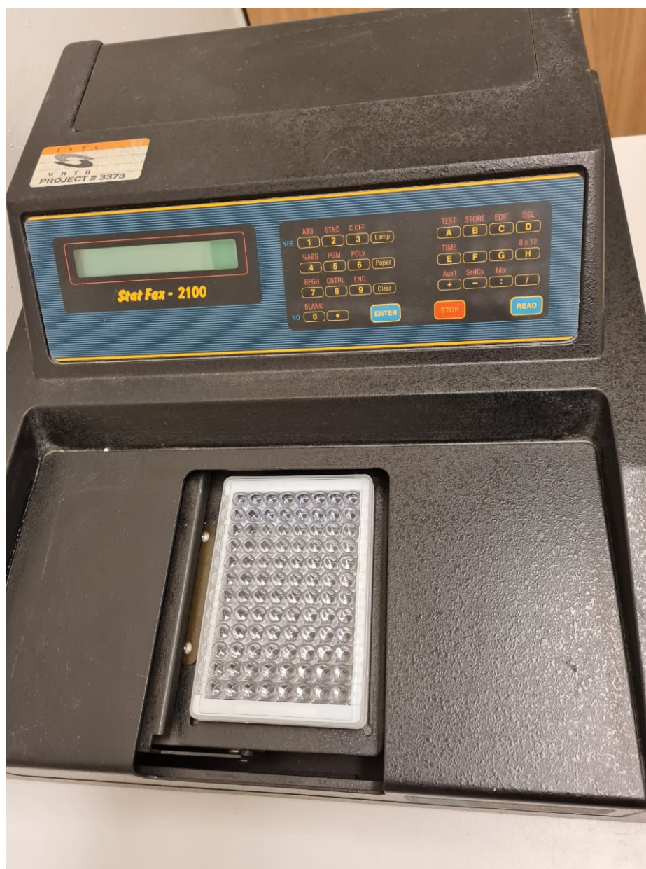
Рисунок 2.7 – Измерение оптической плотности растворов в лунках микропланшетов с помощью спектрофотометра
