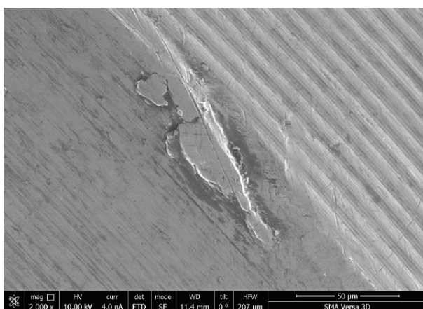
Рисунок 42 – Примеры деформации и дефектов платформы удаленных имплантатов (электронная микроскопия x до 2000 раз)
