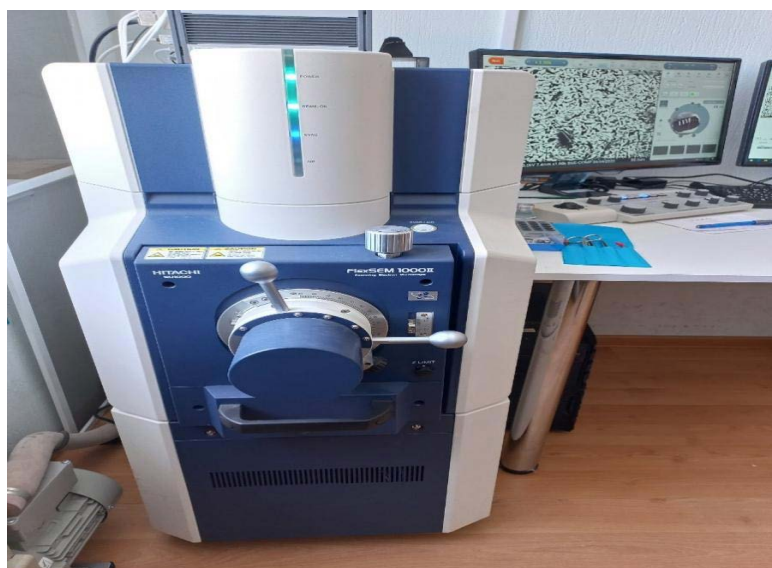
Рисунок 6 – Сканирующий электронный микроскоп Hitachi FlexSem1000 II (Hitachi High-Tech Corporation, Япония)
