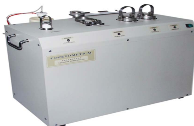
Рисунок 10 – Анализатор удельной поверхности СОРБИ-М (ООО «МЕТА», Россия)
