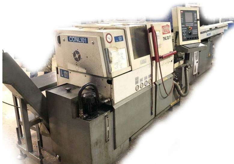
Рисунок 2 – Фрезеровочный 6-координатный станок Traub TNL12 (INDEX TRAUB, Германия)
