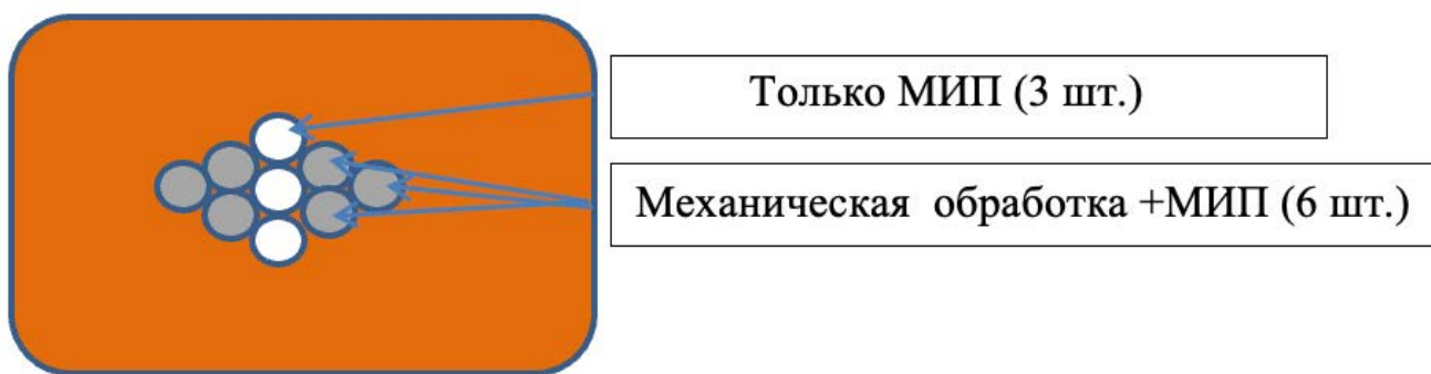
Рисунок 14 – Схема расположения титановых дисков из сплава BT1-0 на медной пластинке
