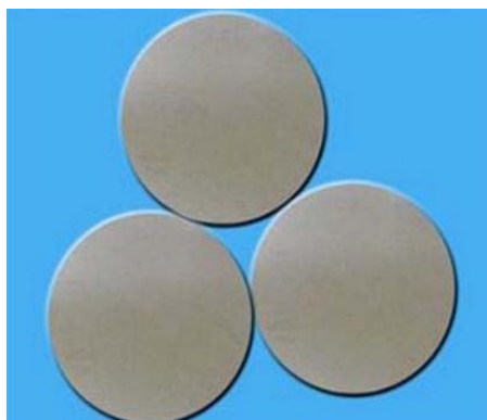
Рисунок 3 – Титановые диски диаметром 6 мм, толщиной 0,3 мм
