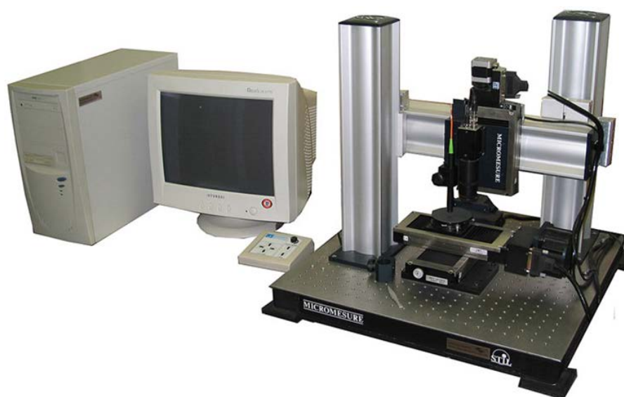
Рисунок 7 – Бесконтактный профилометр Micro Measure 3D Station (STIL, Франция)
